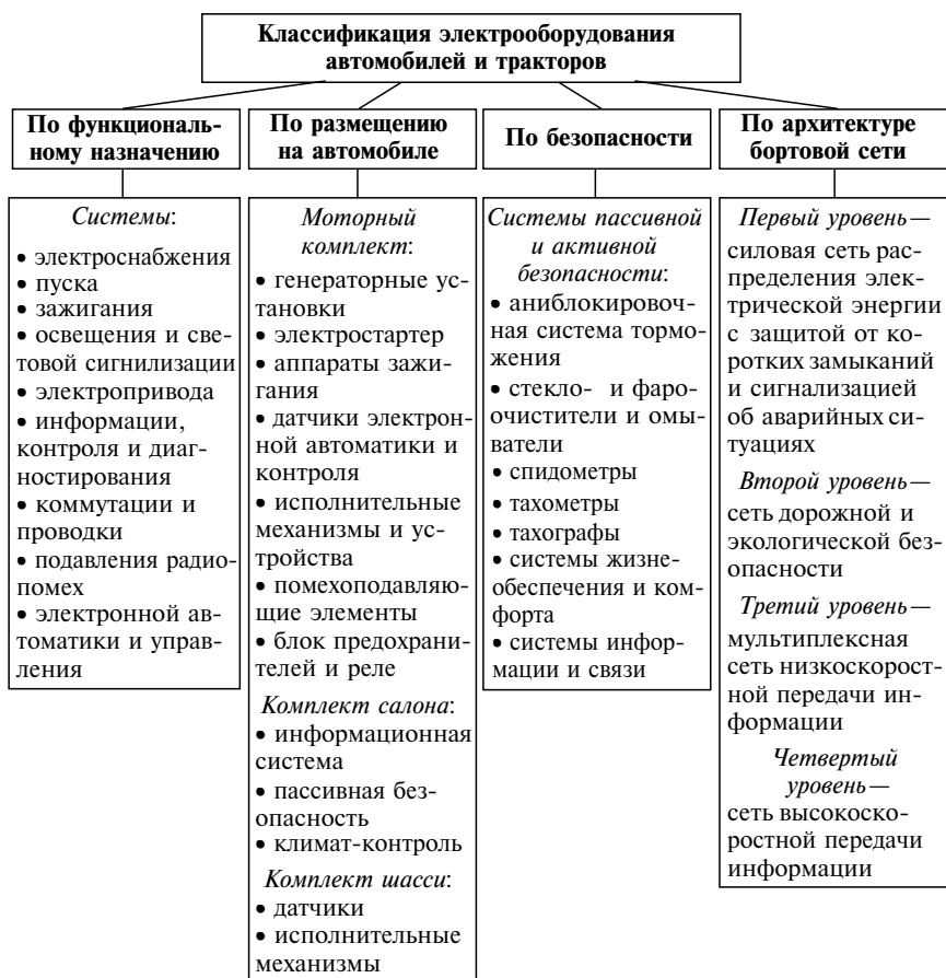
Рис. 1.2. Общая классификация систем электрооборудования автомобилей и тракторов
