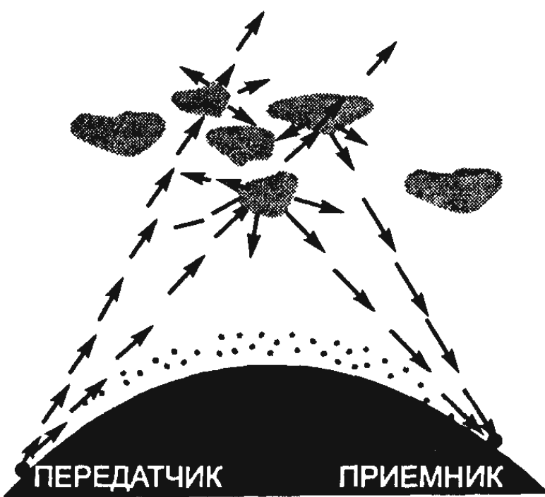
Рис. 11.5,б. Пояснение замираний сигнала за счет отражения волн на неоднородностях тропосферы
