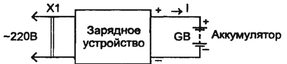
Рис. 2.6. Электрическая цепь, состоящая из зарядного устройства и аккумулятора (здесь аккумулятор является приемником энергии)
