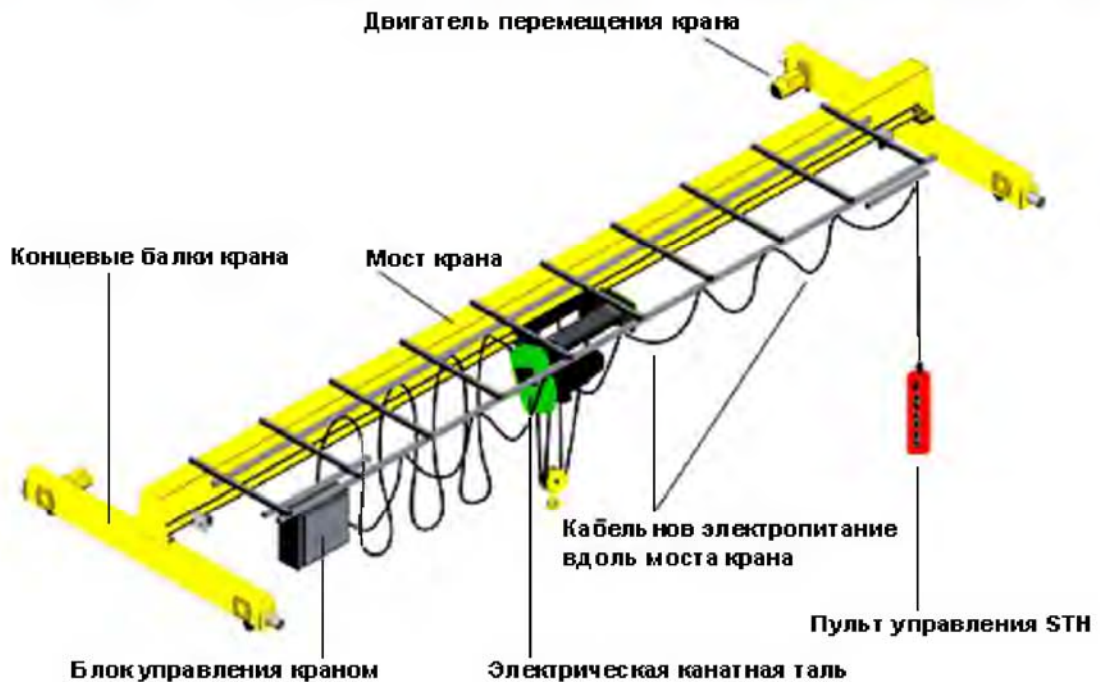
Рисунок 4.45 - Технологическая схема мостового крана
