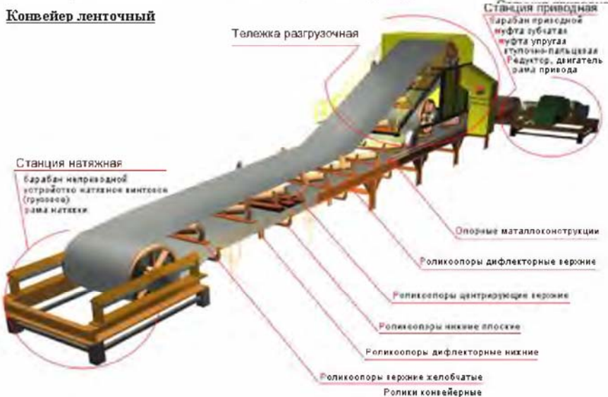
Рисунок 4.10 – Составные элементы и конструкция ленточного транспортера
